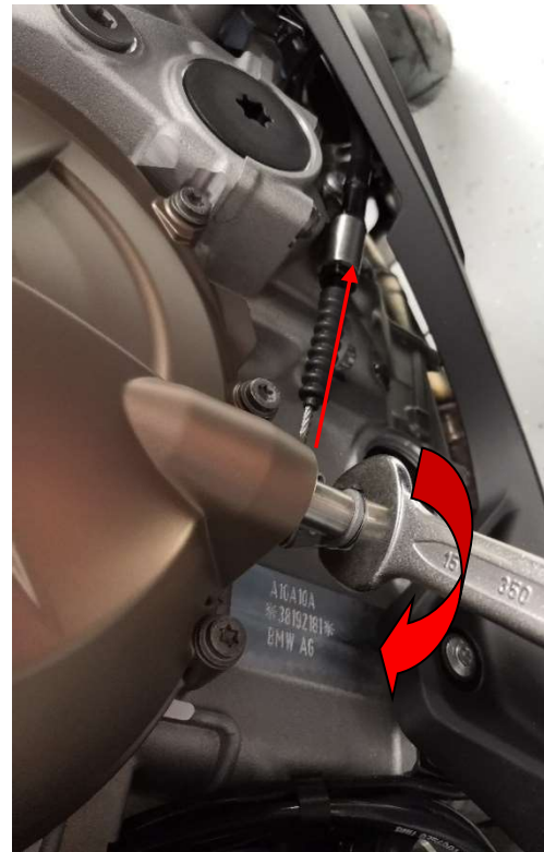
Entlastung des Bowndzugs Deload of the Bowden cable
